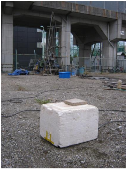
地表計(VSE311M)測定状況
