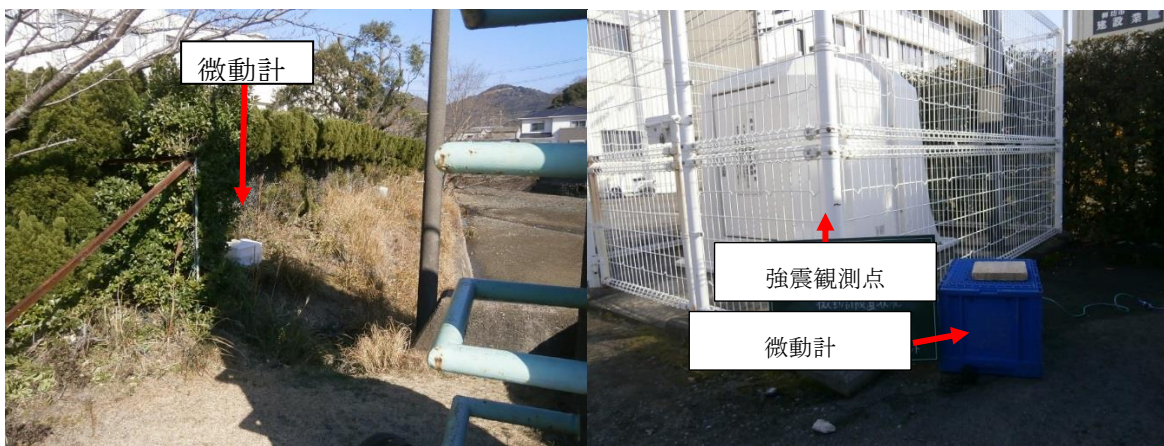
調査地及び強震観測地点での常時微動測定状況例
