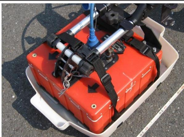
**地中レーダアンテナ装置(400MHz)**
