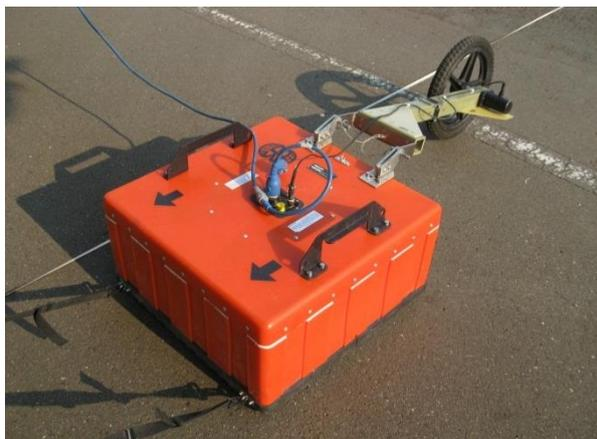
**地中レーダアンテナ装置(200MHz)**
